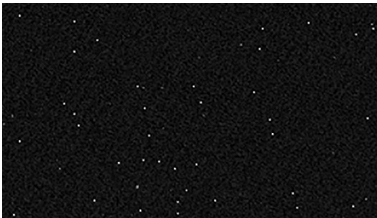
نمونه دارک کیورنت نویز دوربین STF8300M با ۶۰۰ ثانیه نوردهی در دمای -۳۰ درجه سانتی گراد و بستن درب دوربین، عکس: امیرحسین ابوالفتح
